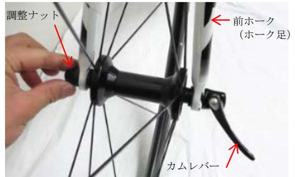
②調整ナットを指先で一杯までねじ込みます。調整ナットを締めるだけでは、車輪を正しく固定できません。
