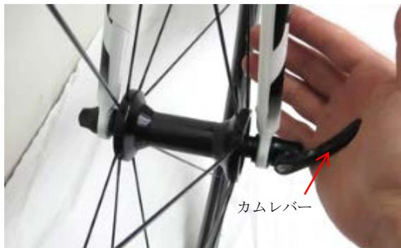
③カムレバーは、手のひらに痛みを感じる位の力で締め付けます。もし、カムレバーが固くて十分倒せないときは、調整ナットを1/4回転緩めます。また、カムレバーが軽すぎるときは、調整ナットを1/4回転締めます。
