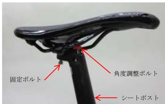
②サドルを動かして前後の位置を調整し、角度調整ボルトを回してサドルの角度を調整します。
