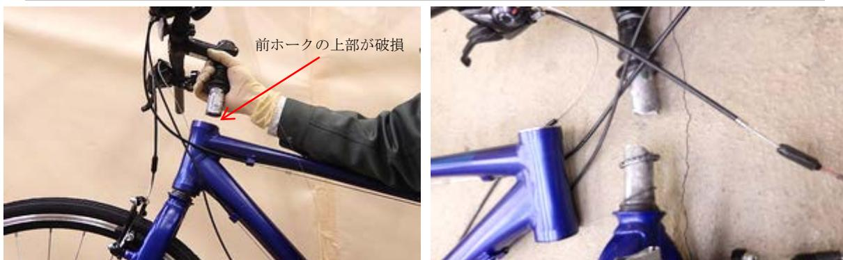
写真5. 軸受け部にガタつきが生じたまま走行した結果、破損したベアリングの様子 (No. 4)
