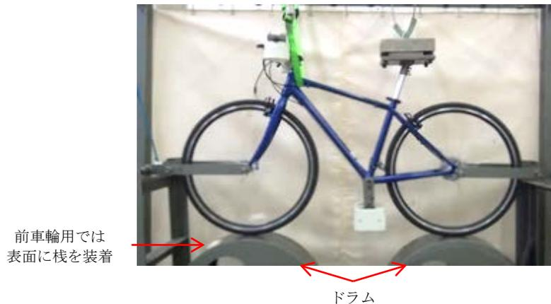
その結果、前ホークの上部や軸受け部の構成部品であるベアリング<sup>(注8)</sup>が破損することがありました(添付資料 1、写真 4、5 参照)。走行中に前ホークが破損すると、それに伴ってハンドルや前車輪が外れ、乗員は路上に投げ出される危険があります。ベアリングが破損した状態で走行すると、ガタつきが増大するほか<sup>そうだ</sup>操舵が円滑でなくなり、ハンドル操作に支障をきたすことなどが考えられ危険です。
