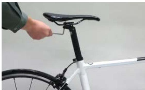
③固定ボルトを締め付けて、サドルを固定します。
