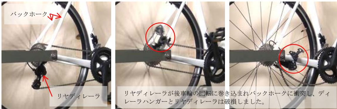
※このテストのため、意図的にディレーラハンガーを後車輪側に向けて大きく曲げた自転車を使用しました。
