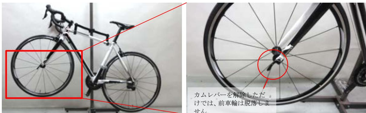
写真 22. 前ホークに装着されている、前車輪の脱落防止を目的とした爪の様子
